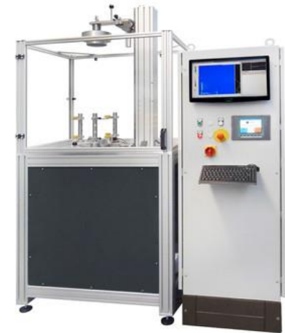
Wirbelstromprüfung von Hohlzylindern mit bildgebender Darstellung
